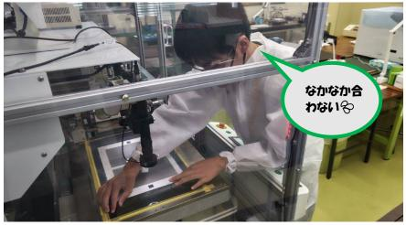
材料を必要な大きさに切り出し加工に 必要な前処理を行います。 ■ この作業は事前に当社が行いました。 ピエゾフィルムに電気を通すための 電極材(銀ペースト)をスクリーン印刷機 という機械を使って印刷しています。 位置合わせがとても難しい作業ですが、 Sくん、難なくクリア!!!
