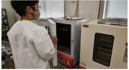
電極を印刷したフィルムを電気炉に入れて乾燥させます。
